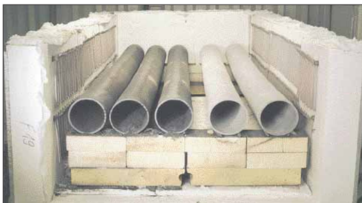
Porównanie rur APM, NiCr po 1000 godzinach w temperaturze 1150°C. Rury NiCr są silnie zanieczyszczone złuszczącą się warstwą ochronną, podczas gdy rury APM są zupełnie czyste.
